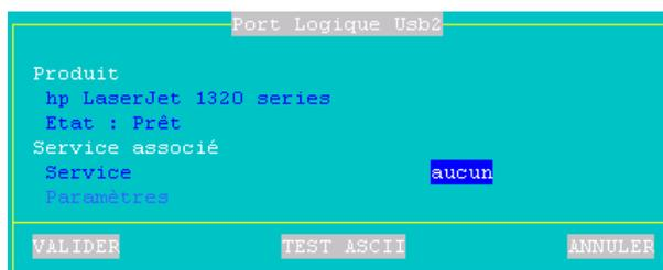
Un port logique USB est automatiquement créé lors de la connexion d'une imprimante. Aucun paramétrage n'est nécessaire pour un port logique USB.
