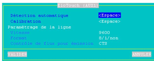
**Détection automatique** : l'appui sur <Espace> déclenche une recherche du type d'écran sélectionné (voir le chapitre 3.2.4). Pour trouver un écran tactile, le terminal parcourt une plage de vitesse et de format. En cas de détection les paramètres de communication (vitesse et format) sont mis à jour.
