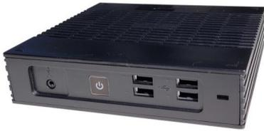
Das Modell 90 bietet sehr performanten **grafischen und textorientierten** Zugriff auf alle gängigen Serversysteme wie Microsoft RDS, CITRIX, UNIX/Linux, AS/400, S/390... Der Client verfügt über **zwei Monitoranschlüsse** zur zeitgleichen Ansteuerung zweier Bildschirme. Durch seine kompakte und leichte Bauform kann er auch an der **Rückseite des Bildschirms montiert** werden. **Optional auch mit Wireless LAN.**
