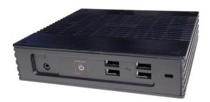
Connectée à un réseau standard **Ethernet TCP/IP** ou **802.11** (réseau sans fil), le client léger Axel modèle 90 permet d'accéder aux applications **textes et graphiques** exécutées sur différents serveurs : Windows, Unix/Linux, AS/400, S/390...
