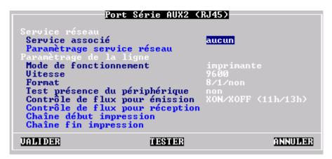
Le bouton **[TESTER]** permet de tester la communication entre le périphérique et la Platine. Quelque soit l'état du port auxiliaire (configuration d'un service, connexion en cours..) l'appui sur ce bouton envoie des données sur le port auxiliaire.
