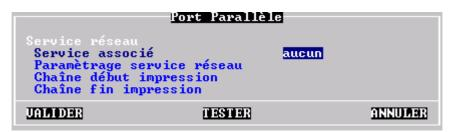
Le bouton **[TESTER]** permet de tester la communication entre le périphérique et la Platine. Quelque soit l'état du port parallèle (configuration d'un service, connexion en cours..) l'appui sur ce bouton envoie des données sur le port parallèle.
