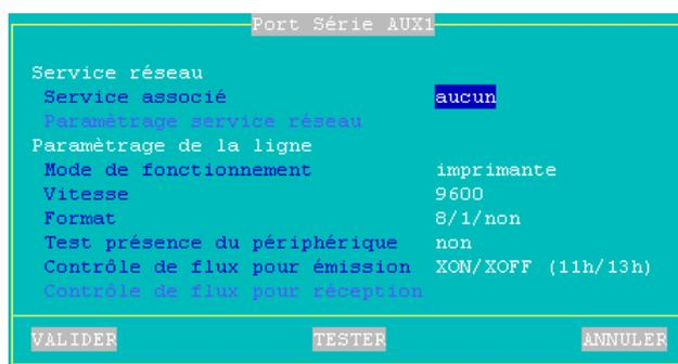
Le bouton **[TESTER]** permet de tester la communication entre le périphérique et la Platine. Quelque soit l'état du port auxiliaire (configuration d'un service, connexion en cours..) l'appui sur ce bouton envoie des données sur le port auxiliaire.
