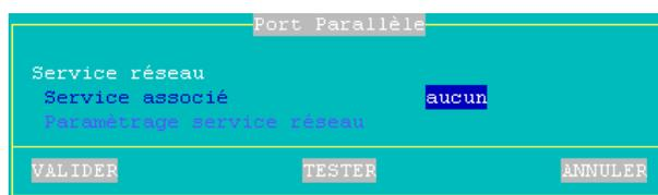
Le bouton **[TESTER]** permet de tester la communication entre le périphérique et la Platine. Quelque soit l'état du port parallèle (configuration d'un service, connexion en cours..) l'appui sur ce bouton envoie des données sur le port parallèle.
