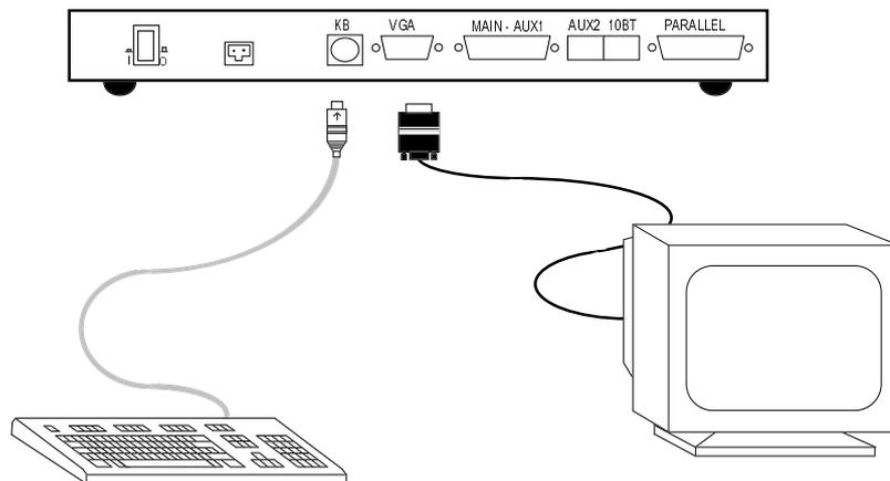
Dans le cas d'un clavier équipé d'une prise din (prise 'gros' modèle, ancien standard AT), utilisez un adaptateur din/minidin.
