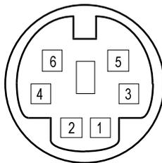
Connecteur clavier (face arrière du modèle 55E)
