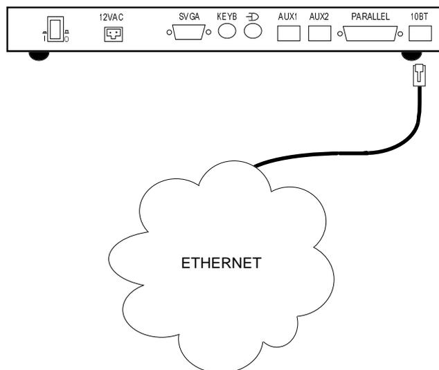
**Note :** lors de la mise sous tension de la Platine, le voyant vert situé à droite de la prise RJ45 doit être allumé. Ce voyant indique la validité de la connexion entre la Platine et le réseau Ethernet (serveur ou hub). Un voyant éteint peut correspondre à un câble Ethernet non conforme aux schémas donnés au chapitre 4.1.
