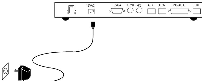
**ATTENTION** : l'utilisation d'un transformateur autre que celui livré par AXEL, peut entraîner des dommages au niveau de la Platine.
