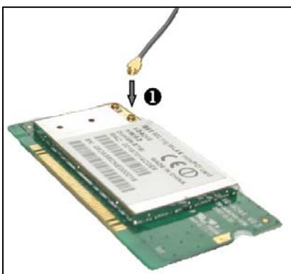
Insérez le module 802.11 dans le slot mini-PCI de la carte électronique de la Platine. Présentez le module incliné à 45° puis effectuez une poussée horizontale ❶. Le module doit se positionner naturellement à l'horizontale et être bloqué par les crochets ❷.
